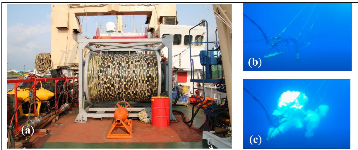
圖三 (a)「海研一號」甲板上活動絞機上的震測信號接收浮纜 (streamer)， (b) 高壓空氣槍於水下拖曳，(c) 高壓空氣槍於水下擊發。
